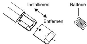
1. Drücken Sie auf die Rückseite des Ferncontrollers an der mit
