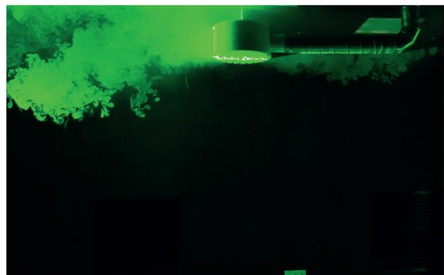
Abb. 1: Visualisierung der Luftströmung (links: vertikales Ausblasmuster; rechts: horizontales Ausblasmuster)
