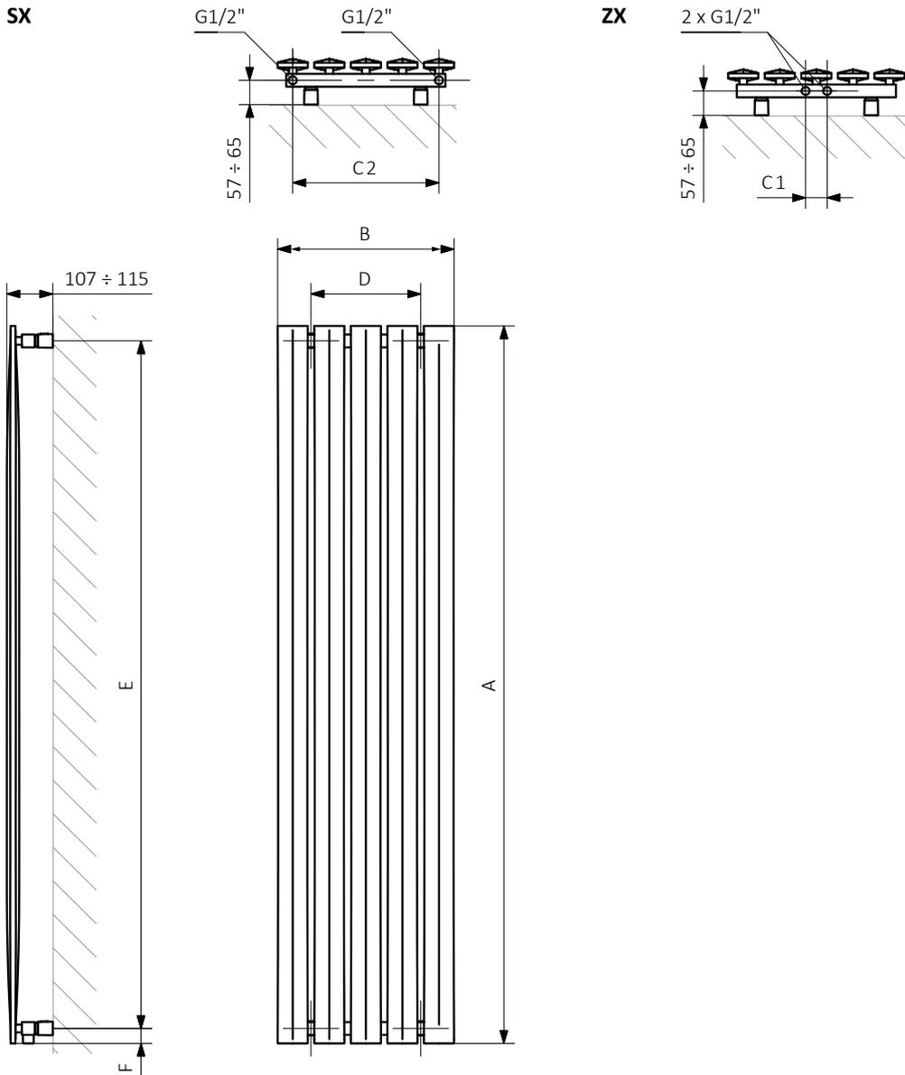
A – Höhe B – Breite C1-C5 – Anschlussabstand D – horizontaler Wandhalterungsabstand E – Vertikaler Wandhalterungsabstand F – Abstand von der Achse der unteren Wandhalterung bis Unterkante des Kollektors
