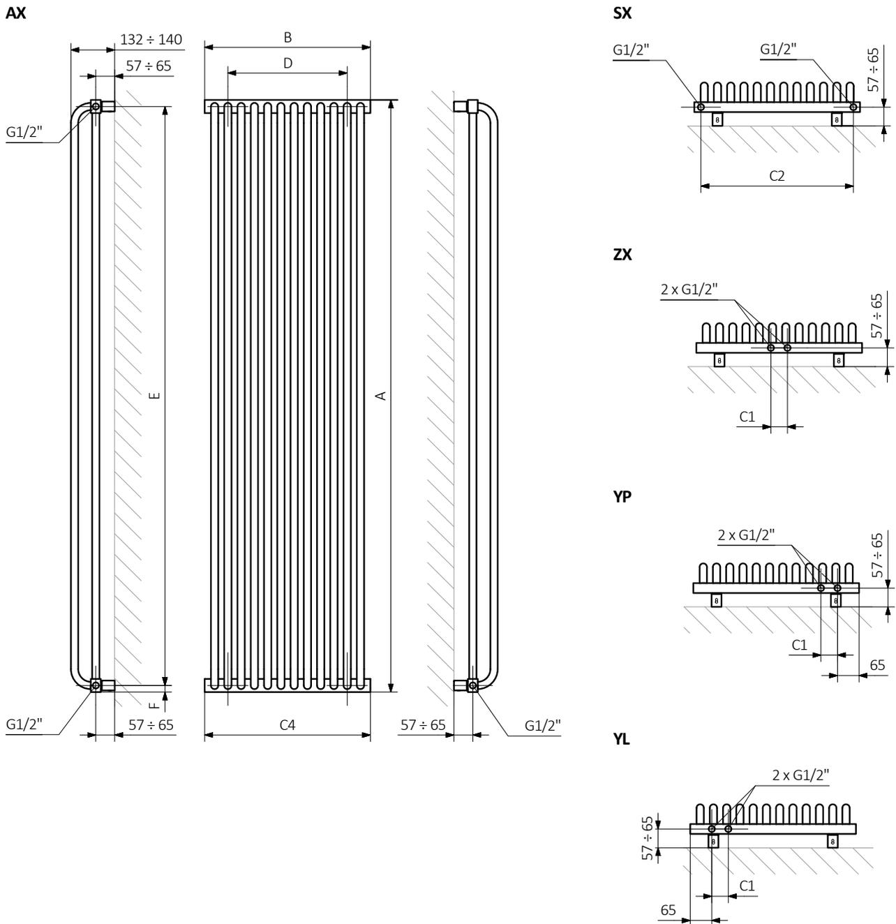
A – Höhe B – Breite C1-C5 – Anschlussabstand D – horizontaler Wandhalterungsabstand E – Vertikaler Wandhalterungsabstand F – Abstand von der Achse der unteren Wandhalterung bis Unterkante des Kollektors
